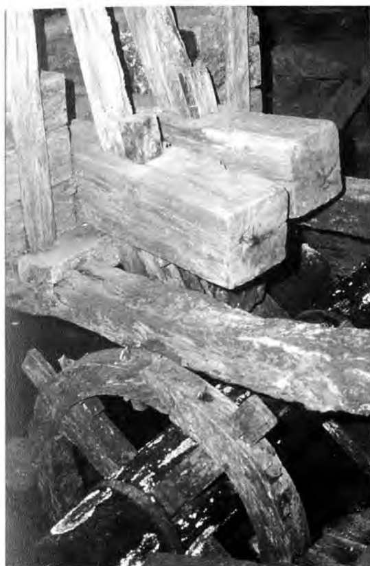
2. As partes básicas do batán: a roda, os mazos e a pía.
