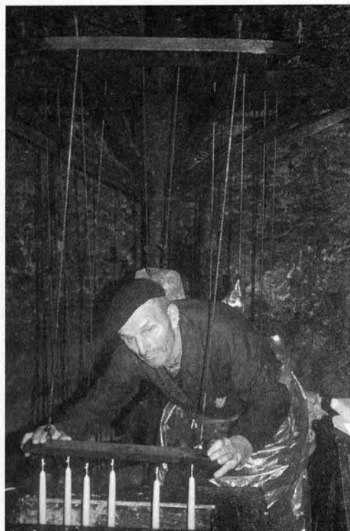
Lám. 15. Cereiro bañando as velas en Negreira (A Coruña).
