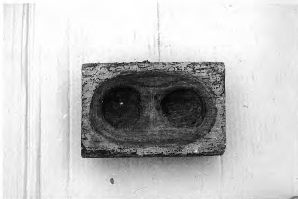
Lám. 21. Molde de madeira para peitos da cerería París de Negreira (A Coruña).
