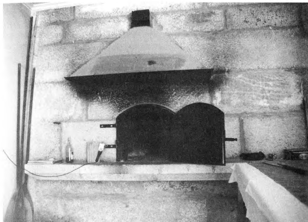
Parte dianteira do forno, coa luz eléctrica móbil e as pas para enformar.
